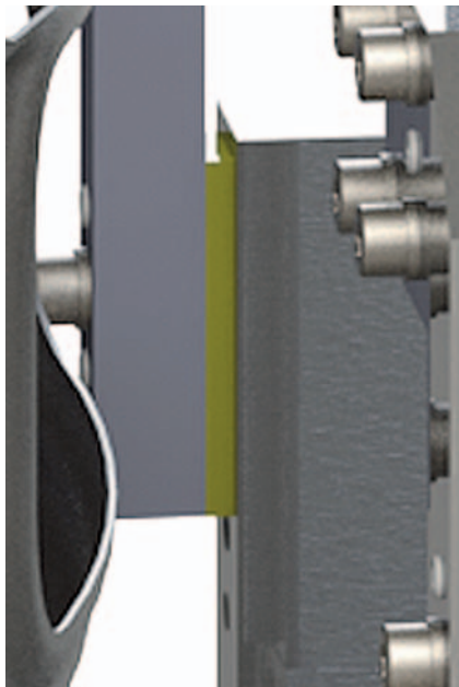
Placas de adaptação usadas na soldadura por resistência e MIG/MAG
